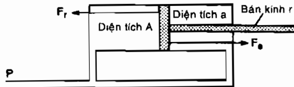
Hình 5-3 Áp suất tác dụng vào cả hai phía piston
